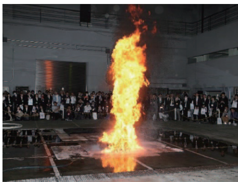
軽油の燃焼実験 [消防研究センター]
